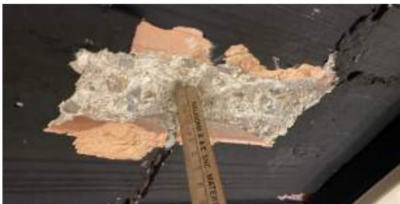
Figura 6 - Saggi effettuati ai solai per determinare il copriferro
